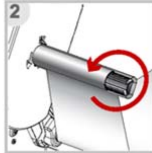
2. Mit zwei Drehungen wird das Etikettenband gespannt.
