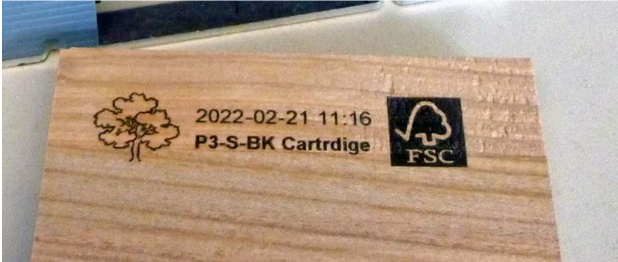
Direktes Beschriften von Holz mit mobilen JetStamp-AS Druckern
