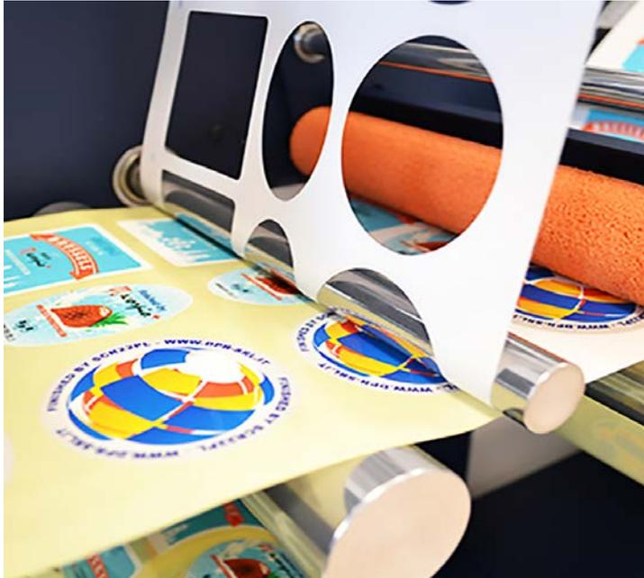
In einem einzigen Durchgang können Sie die Etiketten laminieren, schneiden und entgittern sowie für eine weitere Verarbeitung aufteilen (splitten) und aufrollen.
